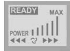
4. Das Display erleuchtet und Sie sehen auf dem Display zunächst für 30 Sekunden die Anzeige ›Ready‹ blinken sowie die Anzeige ›Power‹, ›Max‹, 6 unterschiedliche hohe Balken, 3 Pfeile nach links weisend, ein rotations Symbol sowie 3 Pfeile nach rechts weisend. Nach 30 Sekunden zeigt das Display nur noch die Anzeige ›Ready‹.
