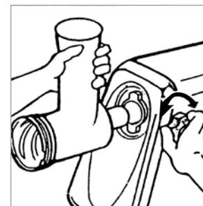
3. Lösen Sie die Klemmschraube rechts am Motorgehäuse einige Umdrehungen gegen den Uhrzeigersinn bis sich das Schneckengehäuse ohne Widerstand aus dem Motorgehäuse herausziehen lässt.
