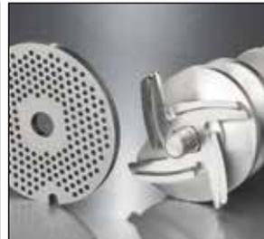
3. Setzen Sie das gewünschte Zubehör (hier: Kreuzmesser und Lochscheibe) ein. Stecken Sie das Kreuzmesser mit der abgerundeten Seite zur Schnecke auf die Achse der Schnecke, so dass die viereckige Öffnung in der Mitte des Kreuzmessers über den Vierkant auf der Achse der Schnecke gleitet.
