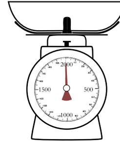
1. Wenn Sie den Wert auf "Null" setzen möchten, drehen Sie den Drehknopf, bis der rote Pfeil auf der Messkala senkrecht nach oben zeigt.
