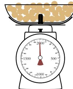
3. Sie können anschließend nach Belieben den Wert zurück auf "Null" stellen, indem Sie wiederholt den Drehknopf drehen, bis der rote Pfeil auf der Messkala senkrecht nach oben zeigt. Die Wiegeschale kann hierbei befüllt bleiben.
