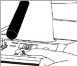
6. Drücken Sie die Color-Taste für den Bräunungsgrad. Die Backzeit ist in 30-Sekunden-Schritten von 2:30-4:00 min einstellbar. Möchten Sie die Waffel knuspriger, drücken Sie die Crisp-Taste (Taste leuchtet blau).
