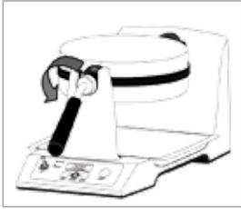
9. Zum Entfernen der Waffel drehen Sie den Handgriff 180° gegen den Uhrzeigersinn und heben den Griff gerade nach oben. Entfernen Sie die fertigen Waffeln sorgfältig mit einem Holz- oder Kunststoff-Spachtel aus der Bodenplatte. Stellen Sie sicher, dass Sie die Heizflächen nicht berühren. Verwenden Sie keine scharfen, spitzen oder metallischen Gegenstände. Das kann zu Schäden an der Antihaft-Oberfläche führen.
