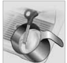
**WARNUNG:** Nehmen Sie die Milchschaumdüse nicht aus der Milch heraus, so lange noch Dampf austritt. Anderenfalls kann heiße Milch aus dem Kännchen spritzen. Schalten Sie den Dampfwechsler immer zuerst in die Ausgangsposition (OFF-Position) zurück, bevor Sie das Milchaufschäumkännchen von der Milchschaumdüse entfernen. Etwa 5 Sekunden nach dem Ausschalten der Dampffunktion tritt ein kurzer Dampfstoß aus der Milchschaumdüse. Achten Sie darauf, sich nicht am heißen Dampf zu verbrühen.
