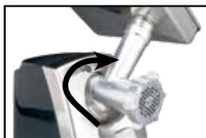
5. Schrauben Sie den Verschlussring vom Schneckengehäuse ab und nehmen Sie die inneren Bauteile aus dem Schneckengehäuse heraus: Die Schnecke mit Kreuzmesser und Lochscheibe, Kebbe-Vorsätze, Wurstfüll-Vorsatz oder Spritzgebäck-Vorsatz.
