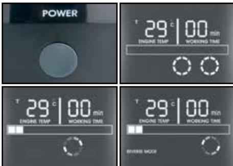
4. Drücken Sie auf den "Power"-Knopf an der Rückseite des Geräts. Das Display erleuchtet und Sie sehen auf dem Display die Motortemperatur, Arbeitszeit und zwei Kreise leuchten.
