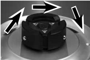
**Achtung:** Bitte gelegentlich die Antriebskupplung (Abb. rechts) mit einem feuchten Tuch reinigen. Besonders darauf achten, dass die Edelstahlkugeln der Siebkorb-Arretierung frei von Saffresten sind. Nach jeder 5. Verwendung des Gerätes jeweils etwas Vaseline auf die Kugeln geben.
