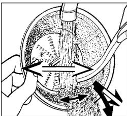
Zum Reinigen des Edelstahlsiebkorbes verwenden Sie am besten die beiliegende Kunststoff-Spülbürste. Fassen Sie den Edelstahlsiebkorb dazu nur am Rand und halten Sie den Edelstahlsiebkorb unter fließendes Wasser. Bürsten Sie dabei vorsichtig von der Mitte nach außen. Halten Sie den Edelstahlsiebkorb gegen das Licht, um zu sehen, ob die Sieböffnungen frei von anhaftenden Rückständen sind.
