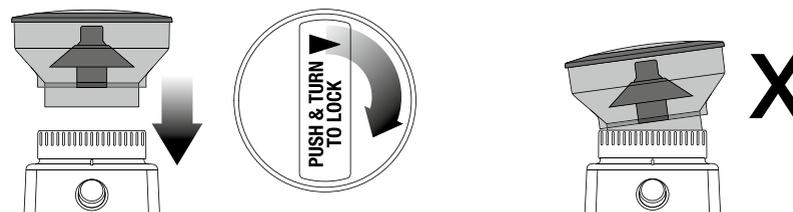
**WICHTIG:** Das Mahlwerk arbeitet nur, wenn der Trichter richtig auf dem Mahlwerk installiert und verriegelt ist. Andernfalls bleibt der Drehknopf GRIND TIME (Mahldauer) auch im eingeschalteten Zustand dunkel und die Taste START/CANCEL bleibt inaktiv.
