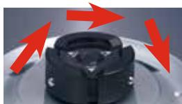
**Achtung:** Bitte gelegentlich die Antriebskupplung (siehe Abb. links) mit einem feuchten Tuch reinigen. Besonders darauf achten, dass die Edelstahlkugeln der Siebkorb-Arretierung frei von Saftresten sind. Nach jeder 5. Verwendung des Gerätes jeweils etwas Vaseline auf die Kugeln geben.
